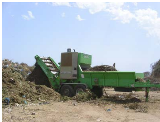
Procés de trituració de poda per addicionar a la matèria orgànica.
